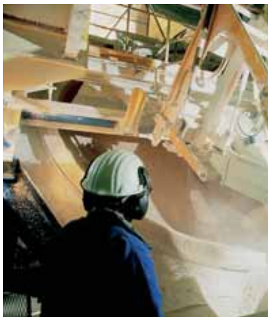
Dans l'usine d'Axens Salindres, ce drageoir permet d'obtenir, sous forme de billes, des adsorbants et des supports servant à la fabrication de catalyseurs.
